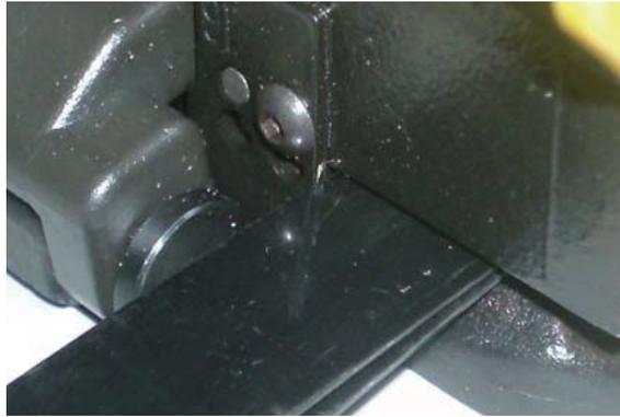
**INSERT THE STRAP INTO THE SEALING SECTION AGAINST THE WALL OF HOUSING**
